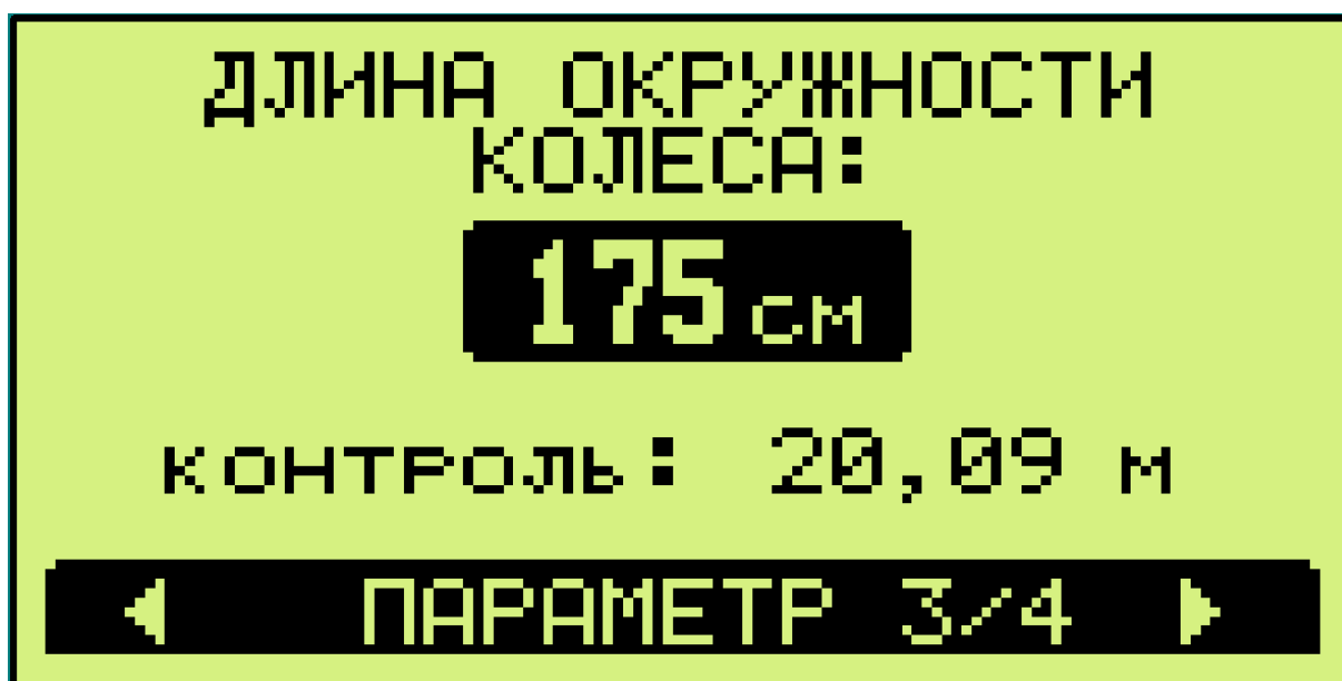
Рисунок 6. Настройка длины окружности колеса и контрольный одометр
